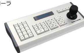
PTZカメラの旋回・ズームを始め、プリセット登録やツアーセット等の各種設定を行う専用コントローラです。
